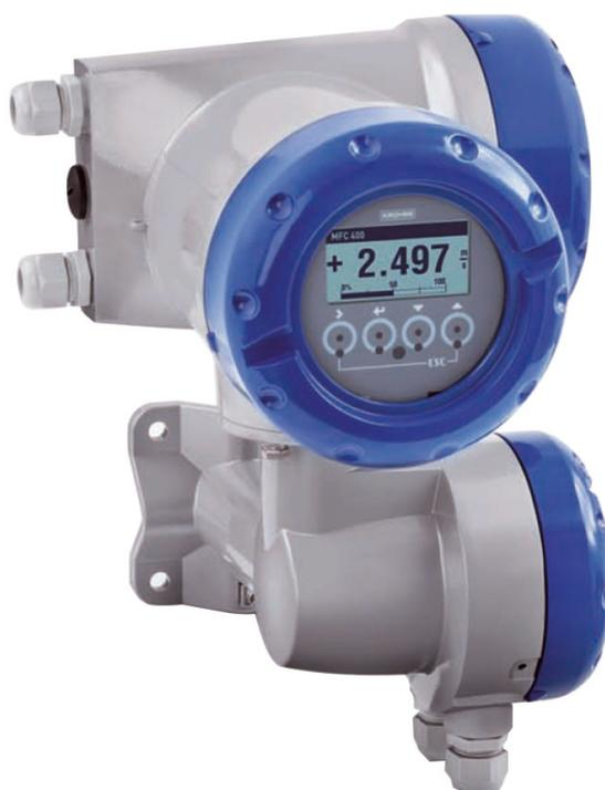
UFC 400 представляет собой 4-проводный ультразвуковой преобразователь сигналов. В комбинации с первичным преобразователем расхода OPTISONIC 3000 он образует врезной ультразвуковой расходомер OPTISONIC 3400 для измерения расхода жидкостей и учёта тепловой энергии. В комбинации с первичным преобразователем расхода OPTISONIC 4000 (НТ/НР) он образует врезной ультразвуковой расходомер OPTISONIC 4400 (НТ/НР) для измерения расхода жидкостей с высокой температурой и под высоким давлением.
