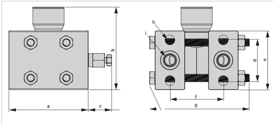
Рисунок 2-10: Технологическое присоединение 1/4 NPT из Hastelloy C-276 с воздушным клапаном на технологической оси (HR)
