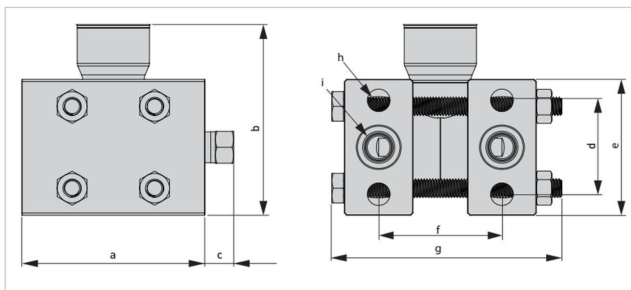
Рисунок 2-9: 1/4 NPT без воздушного клапана, Технологическое присоединение из Hastelloy® C-276 (HO)
