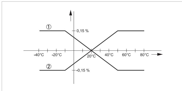
Рисунок 2-15: Влияние температуры окружающей среды на токовый выход
