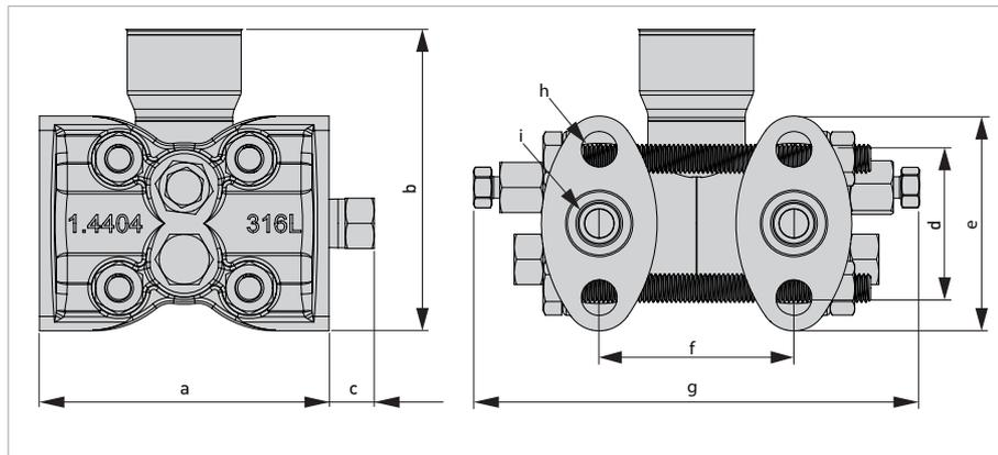
Рисунок 2-6: 1/2 NPT с воздушным клапаном (SD)
