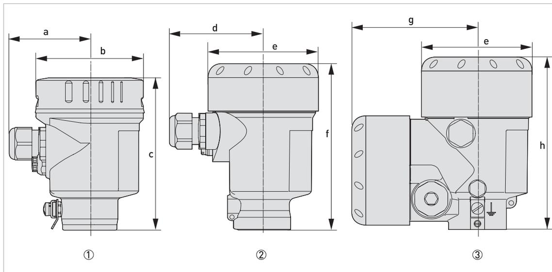
Рисунок 2-2: Корпус из нержавеющей стали
