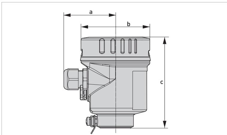
Рисунок 2-3: Нержавеющая сталь (электрополированная) в исполнении IP69K
