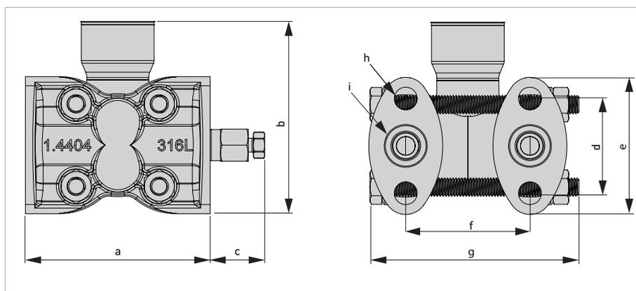
Рисунок 2-7: 1/4 NPT с вентиляцией на технологической оси (SR)
