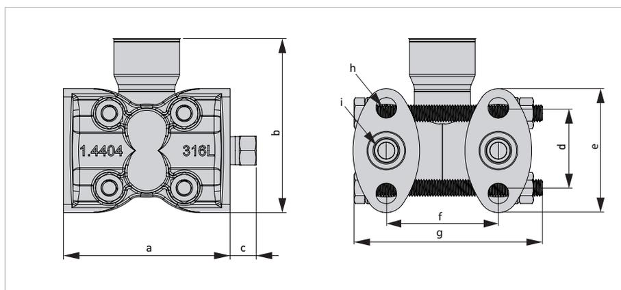
Рисунок 2-5: Технологическое присоединение без воздушного клапана (SO) 1/4-18 NPT
