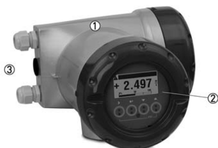
(конвертер сигналов в корпусе компактного исполнения)
