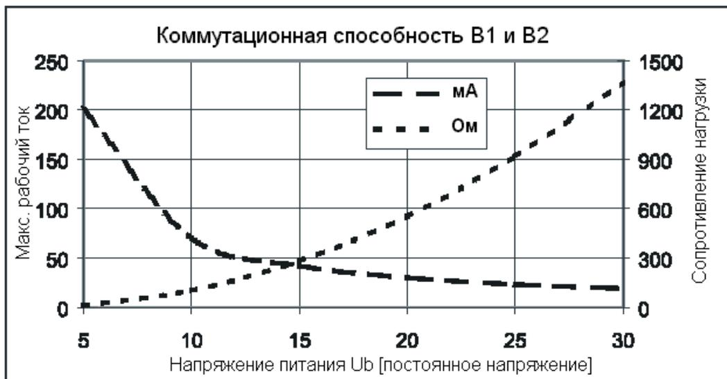
Падение мощности на выходах В1 и В2 максимум 500мВт. Минимально допустимое сопротивление нагрузки может быть определено по диаграмме.
