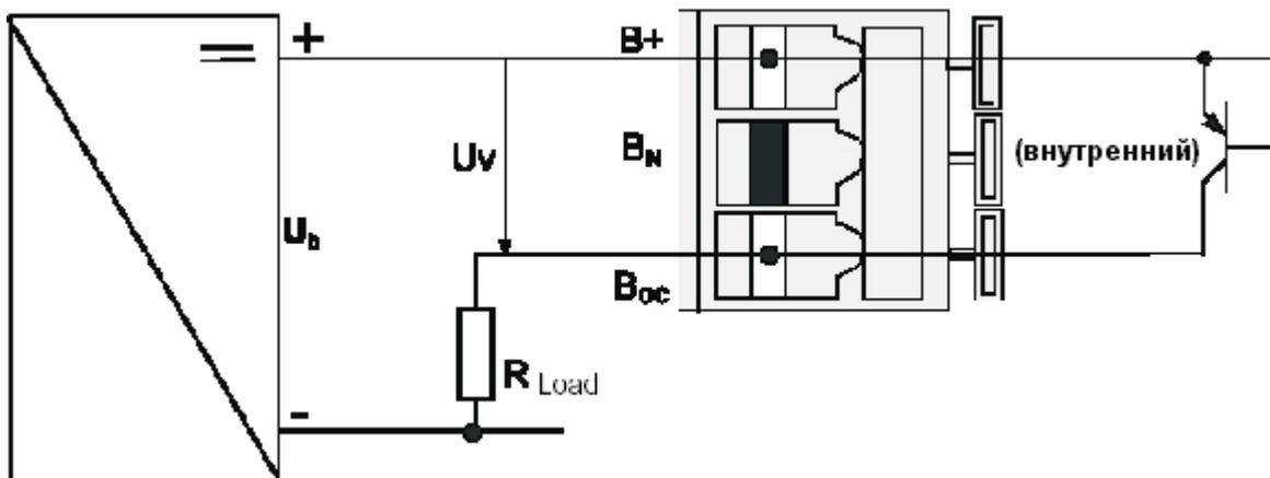
$U_b = 8 \dots 30\text{В}$  пост. напряжения
